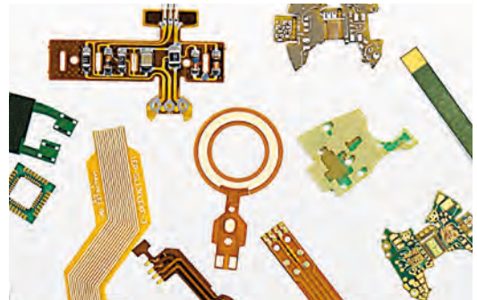
Laserkonturschneiden von Leiterplatten aus Kapton (Polyimid) und FR4
